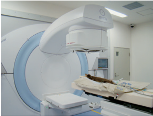
図2 リニアック（直線加速器）とその治療の実際
